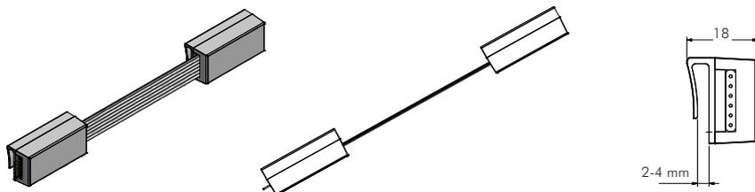
Kabelmodule dienen zur längeren Überbrückung zwischen Leuchtmodulen. Durch das biegsame Flachbandkabel können auch verzweigte Elemente angefahren werden.
